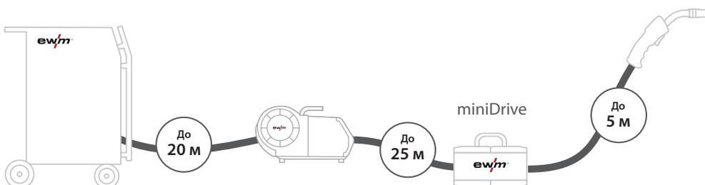
Пример системы: декомпактный сварочный аппарат + механизм подачи проволоки + miniDrive
