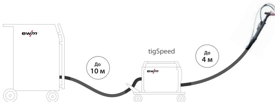
Пример системы: аппарат для сварки TIG + tigSpeed + сварочная горелка
